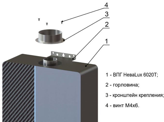
Рисунок 4. Монтаж-демонтаж горловины
