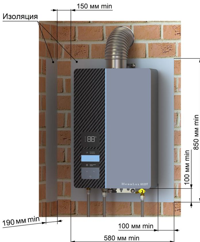
Рисунок 3. Установка аппарата на трудносгораемых стенах
